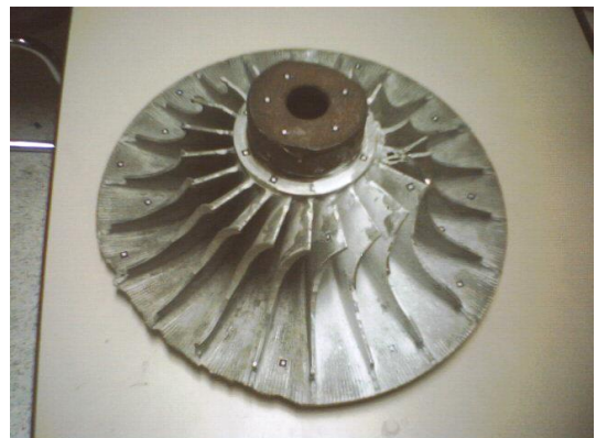
รูปที่ 4 แสดงลักษณะของกังหันต้นกำลังที่เสียหายเพื่อนำมาเก็บค่าพิกัดจุด (Clouds of Points)
