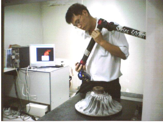
รูปที่ 5 แสดงการใช้อุปกรณ์อุปกรณ์เก็บค่าพิกัดสามมิติระบบแสงเลเซอร์ (3D Laser Scanner) กลุ่มพิกัดจุด (Clouds of Points) ของต้นแบบกังหันต้นกำลัง
