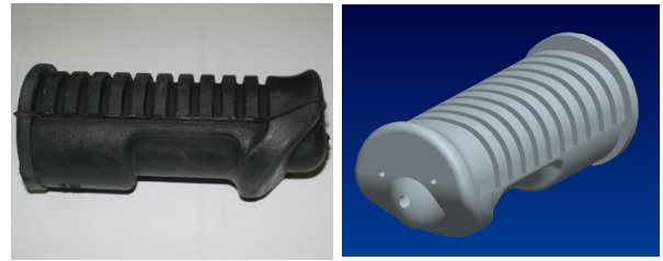
รูปที่ 1 ยางที่วางทำที่ใช้ในการเหยียบเบรกในรถจักรยานยนต์
