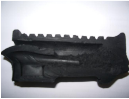
รูปที่ 16 ภายในของชิ้นงานที่เนื้อยางไม่สุกบริเวณที่ติดกับตัว Insert
