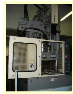
รูปที่ 2 เครื่องฉีดยางแบบแนวตั้งขนาด 100 ตันและมีปริมาตรกระบอกฉีด 254 ลูกบาศก์เซนติเมตร
